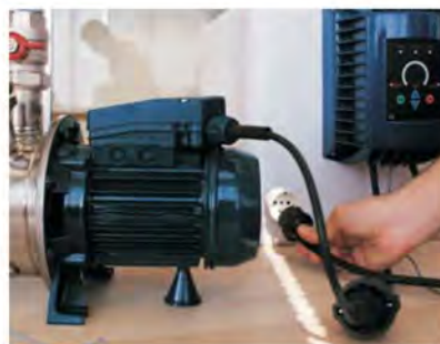
7) Collegare l'Inverter alla rete di alimentazione elettrica
