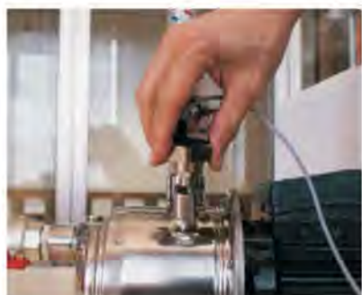
3) Installare il sensore di pressione
