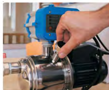
5) Installare il sensore di pressione
