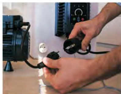
6) Connettere elettricamente l'inverter alla elettropompa
