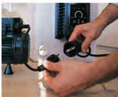
4) Connettere elettricamente l'inverter alla elettropompa
