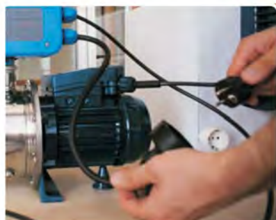
3) Scollegare il cavo elettrico che alimenta il controllo pressione
